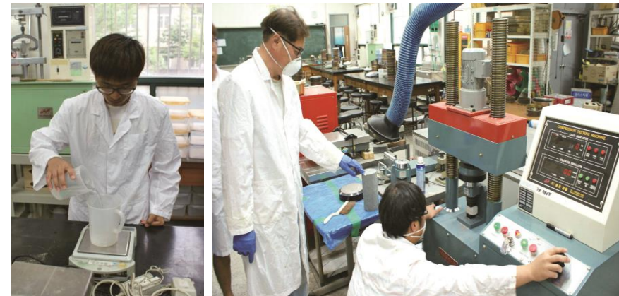
그림 2 한국표준 시멘트 모르터 강도 재료 시험
